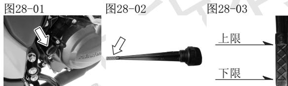
按照下列步骤检查发动机机油的油位。
