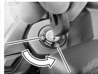
为了锁定转向机构，先将车把转向极左位置，在“⊗”位置将钥匙按到底，逆时针方向转到“🔒”位置。此时钥匙可以拔出。点火电路切断。
