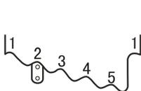
后减震器的缓冲弹簧, 可根据驾驶者的愿望、承载状况、驾驶方式和道路条件等因素加以调整。调整可任选五个位置之一, 只要把车辆用停车架支稳后, 把弹簧调节器转到所需要的位置。第1位置最软, 第5位置最硬。本型号车出厂时都暂定在第2位置。
