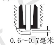
用硬铁丝或钢钎把火花塞上附着的积碳清除。再用塞尺检查火花塞电极的间隙，将电极的间隙调整到0.6~0.7毫米之间。
