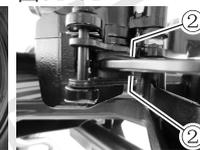
检查制动盘的要领是:看该制动盘的厚度①是否小于3.5毫米。如果厚度小于3.5毫米,就应换新制动盘。
