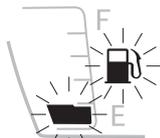
燃油表分5段显示。当5段均为实心框体时(见图11-01),表示燃油已接近满箱。当1段及低油位警示灯<sup>⑮</sup>一起闪烁时(见图11-02),油箱剩下的油量大约为:1.5升,请尽快添加燃油。
