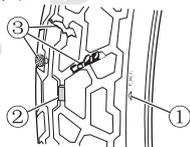
目视检查轮胎磨损情况和轮胎表面的损坏情况③(刺穿或裂缝)。轮胎过度磨损或轮胎表面有过多的损坏会影响行驶稳定性，请更换轮胎。
