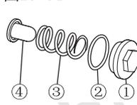
应按照“定期维护保养表”中的周期清理机油滤网。机油滤网的清理步骤如下：
