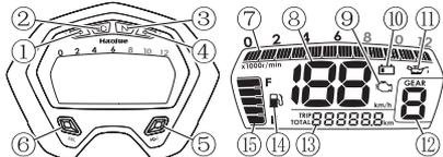
点火开关由“”转为“”位置时，仪表先进行开机自检：低油位警示灯⑭、机油更换提示灯⑪和蓄电池充电提示灯⑩点亮一次，液晶屏幕上所有可显示的内容进行扫屏。以上完成后仪表恢复正常指示。
